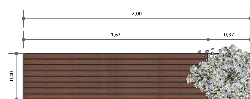
6 BANCO DE CONCRETO VISTA SUPERIOR ESCALA 1:20
