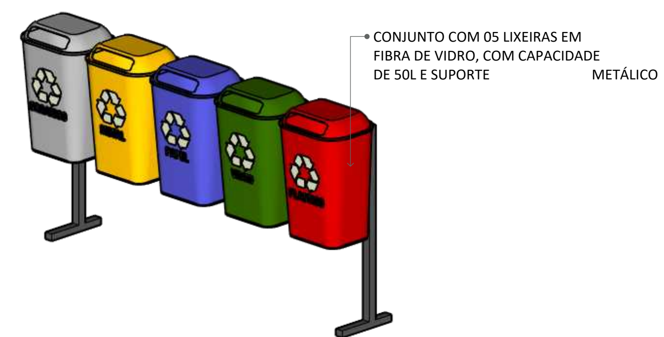
4 PERSPECTIVA ISOMÉTRICA LIXEIRA SELETIVA ESCALA 1:20
