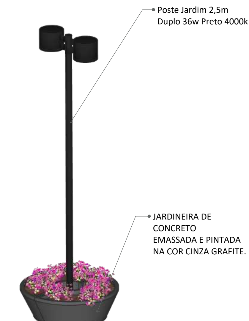
4 PERSPECTIVA ISOMÉTRICA JARDINEIRA COM POSTE ESCALA 1:30
